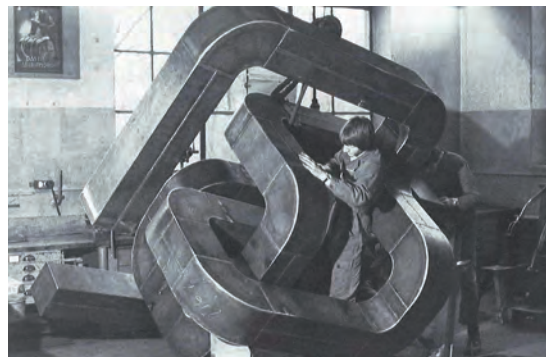
Freiplastik als Schweisskonstruktion in Cor-Ten-Stahlblech 3 mm; Gewicht 900 kg, 1975. Entwurf und Auftrag von Herrn Marcel Perincioli, Bildhauer. Ausführung durch die Metallbauabteilung.
